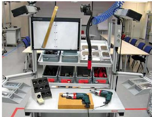
Bild 3: Einzelplatz-/Komplettmontage: Zu sehen ist ein Arbeitsplatz für die Komplettmontage eines Produktes. Hohe Flexibilität, kein Transport und ein flexibles Flächenlayout zählen zu den Vorteilen.
