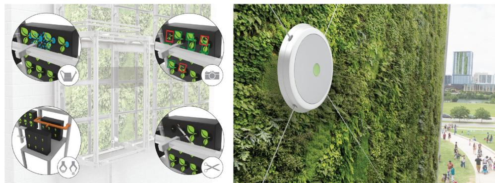
Abbildung 53 Links: Mögliche Aufgaben, die mit dem Green Wall Robot entsprechend dem Kontext seiner Implementierung durchgeführt werden können; Rechts: Design-Studie eines Green-Wall-Robot-Konzepts als Kabelroboter (Quelle: Fraunhofer IPA und Nina Kraus, Industrial Design, Staatliche Akademie der Bildenden Künste Stuttgart)
