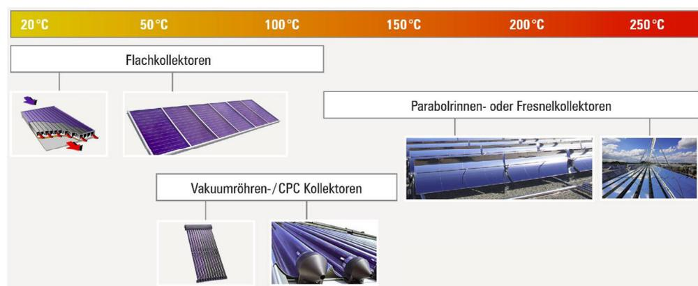
Abbildung 47 Solarkollektortypen für solare Prozesswärme [49]
