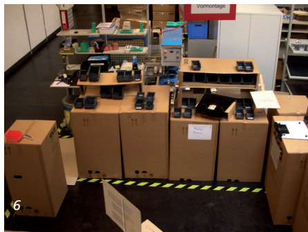
5-7 | Mit Cardboard neu gestaltete und anschließend realisierte Montage-Arbeitsplätze
