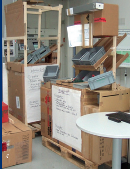
1&2 | Mit Cardboard neu gestalteter Arbeitsplatz und realisierter Arbeitsplatz
